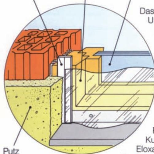
Das TURINO-FD kann auf einer Unterlage, beispielsweise einem Fenster- oder Türstock aufgeklebt werden, während die andere Seite, ähnlich wie bei einem Doppelklebeband, eine Klebefläche für eine Schutzfolie besitzt.
